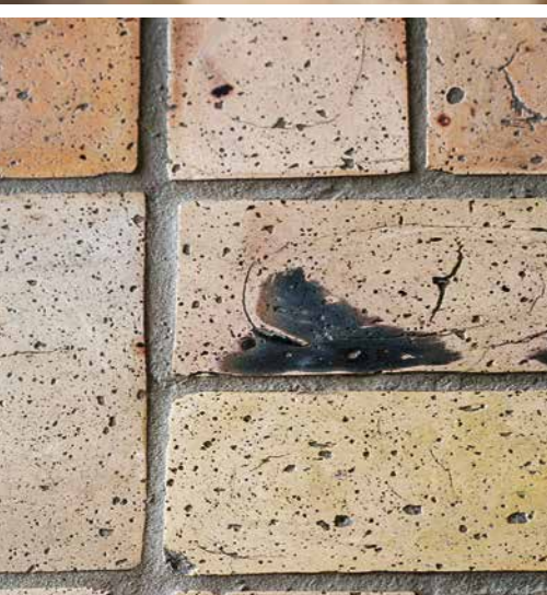
Vor allem bei den hellen Fliesen (diese stammen aus dem Raum Halle a. d. Saale) wirken die schwarzen Brandstellen. Solche Ziegel lagen beim Brennvorgang zu nah am Feuer.
