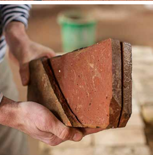
Fast fertig: Aus einem Mauerziegel entstehen zwei Fliesen. Das Zuschneiden erfordert Genauigkeit.
